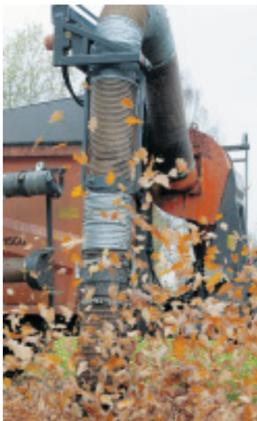
Laubsauger: Der Schlaucharm mit etwa 50 Zentimetern Durchmesser schwenkt hin und her um die Blätter in seinen Tank zu befördern. Acht Kubikmeter passen hinein.
